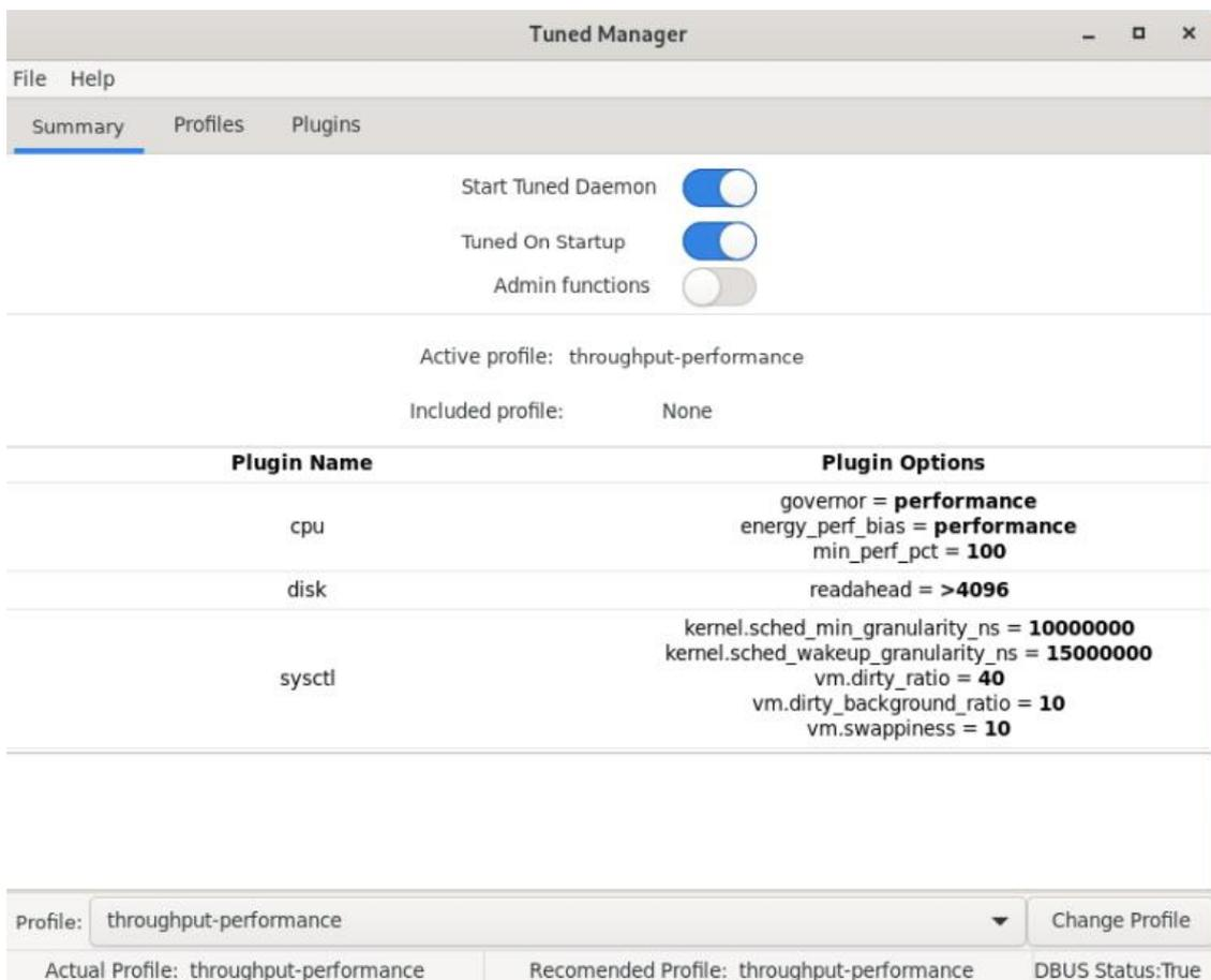
图 3-42 tuned-gui 窗口
